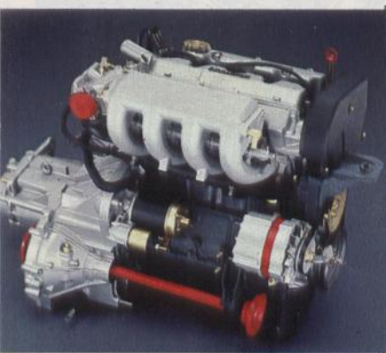
● Il motore della Prisma integrale deriva dal due litri della Thema e dispone degli alberi controrotanti di equilibratura.
