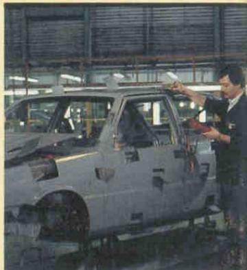
Una scocca della «Prisma» prelevata a caso dalle linee di verniciatura viene «sezionata» (e distrutta) affinché il laboratorio chimico dello stabilimento possa verificare l'efficienza dell'impianto di cataforesi ad alto spessore. A Chivasso lo strato di fondo cataforetico (un misto di resina epossidica e altre) elettrodepositato sulle scocche per proteggerle dalla corrosione è alto da 25 a 35 micron, contro i 13-17 micron rilevabili negli impianti tradizionali.
