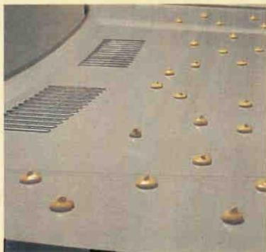
Nello stabilimento Lancia di Chivasso le ossature interne delle porte e dei cofani vengono fissate mediante adesivo strutturale. Questo sistema consente tra l'altro di apporre sulle flangiate perimetrali una doppia sigillatura anticorrosiva. Nella foto: i blocchetti di collante solido predisposti all'interno di un cofano, in attesa dell'ossatura. Dopo il passaggio in forno si otterrà una saldatura indissolubile ma nello stesso tempo elastica.
