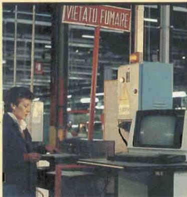
Una delle 11 stazioni video che formano il sofisticato sistema centralizzato di controllo della qualità Lancia chiamato «passa parola». In ogni stazione un collaudatore esamina il lavoro eseguito su ciascuna scocca nel tratto di linea precedente, e tramite una scheda segnala all'elaboratore centrale quanto ha riscontrato. L'elaboratore memorizza le schede ed evita così che un difetto possa ripetersi, facendo scattare un preallarme o un allarme.
